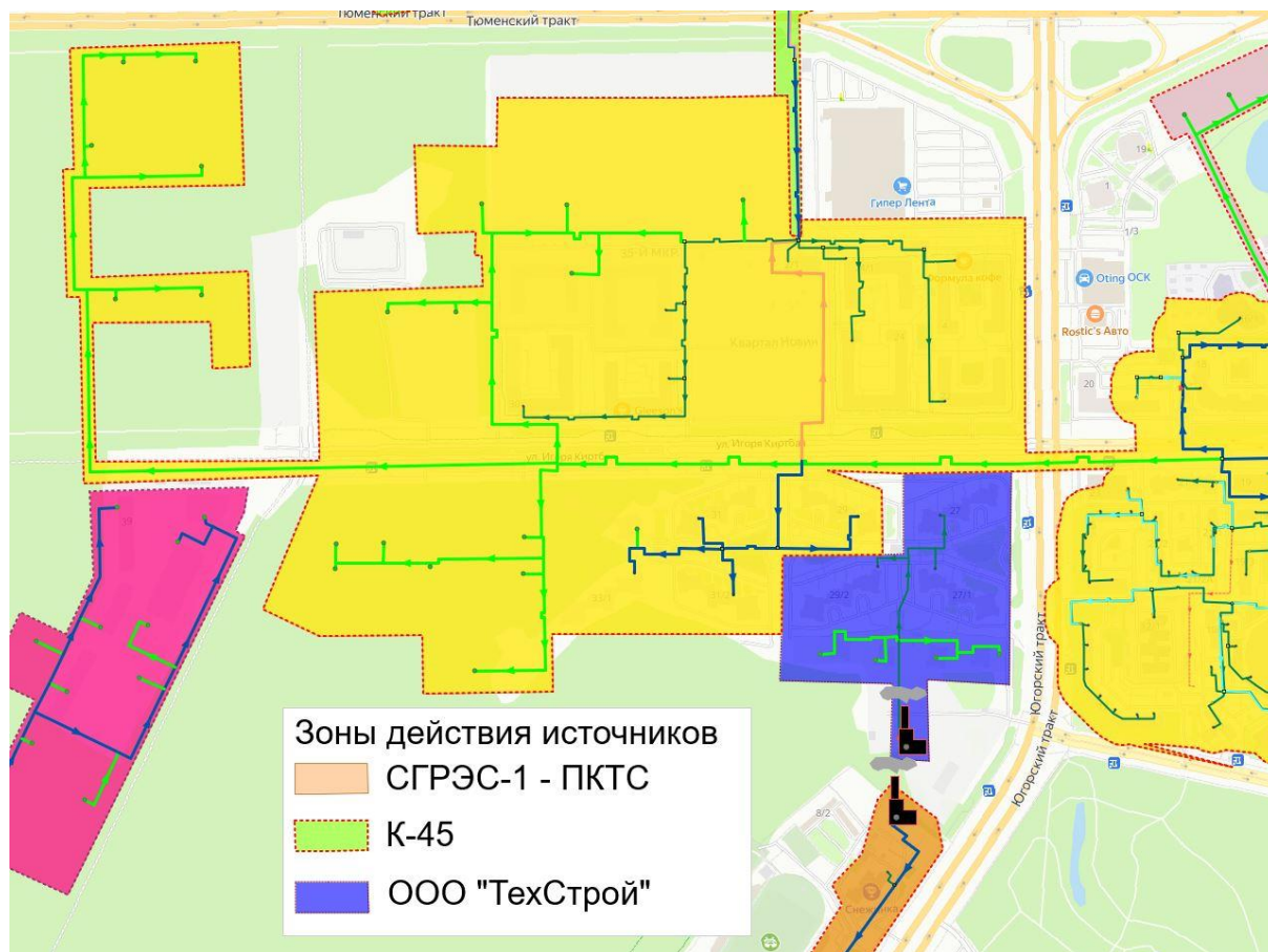
Рисунок 4.28 – Зона действия СГРЭС-1 – ПКТС после переключения потребителей микрорайона 35 с котельной К-45
